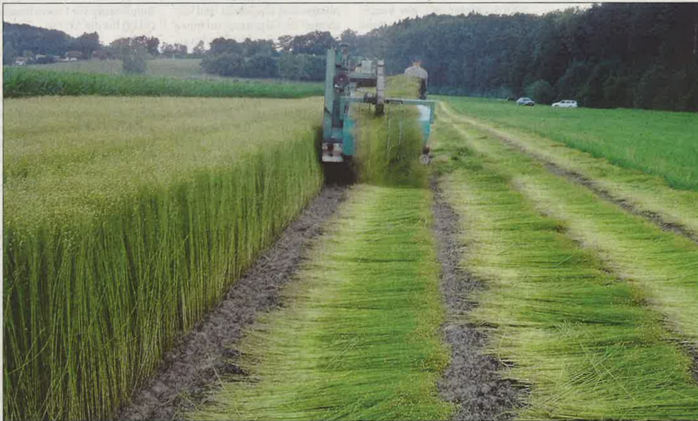
Mit dieser Spezialmaschine wird der Flachs nicht gemäht, sondern aus dem Boden gezupft. Nach dem Zupfen bleibt der Flachs einige Tage auf dem Feld liegen, bevor er nach dem Wenden und Entkapseln zu grossen Ballen geformt wird.
